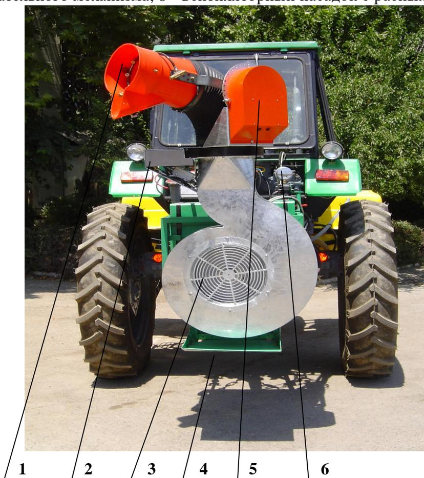
**Рисунок 2 - Опрыскиватель вентиляторный универсальный VP-1. Вид сзади.**
